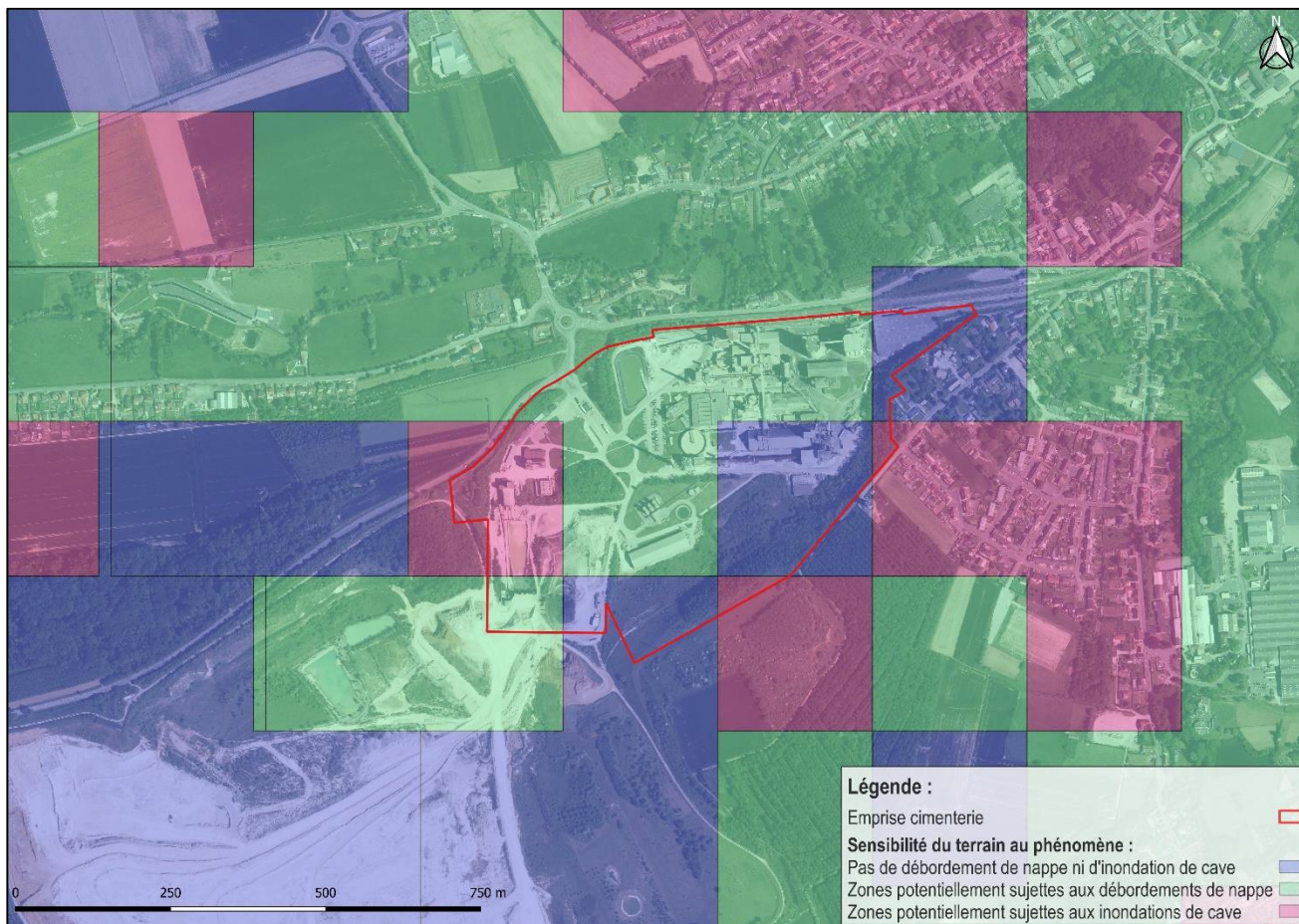
Figure 13 : Sensibilité des terrains au phénomène d'inondation par remontées de nappe
